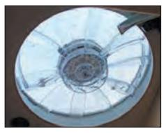
Figure 13-5: Overhead vent fan
