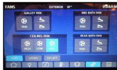
Figure 15-7: Vent Fan Switch
