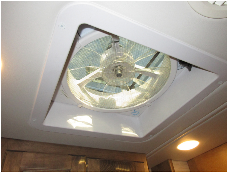
Fig. 14-3: Overhead Vent Fan
