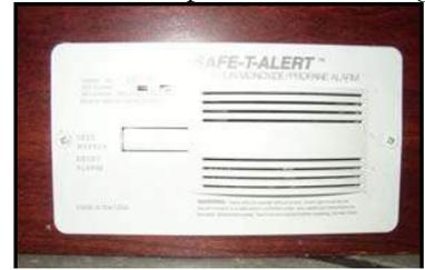
**Figure 3-9. CO/LP Gas Detector**
